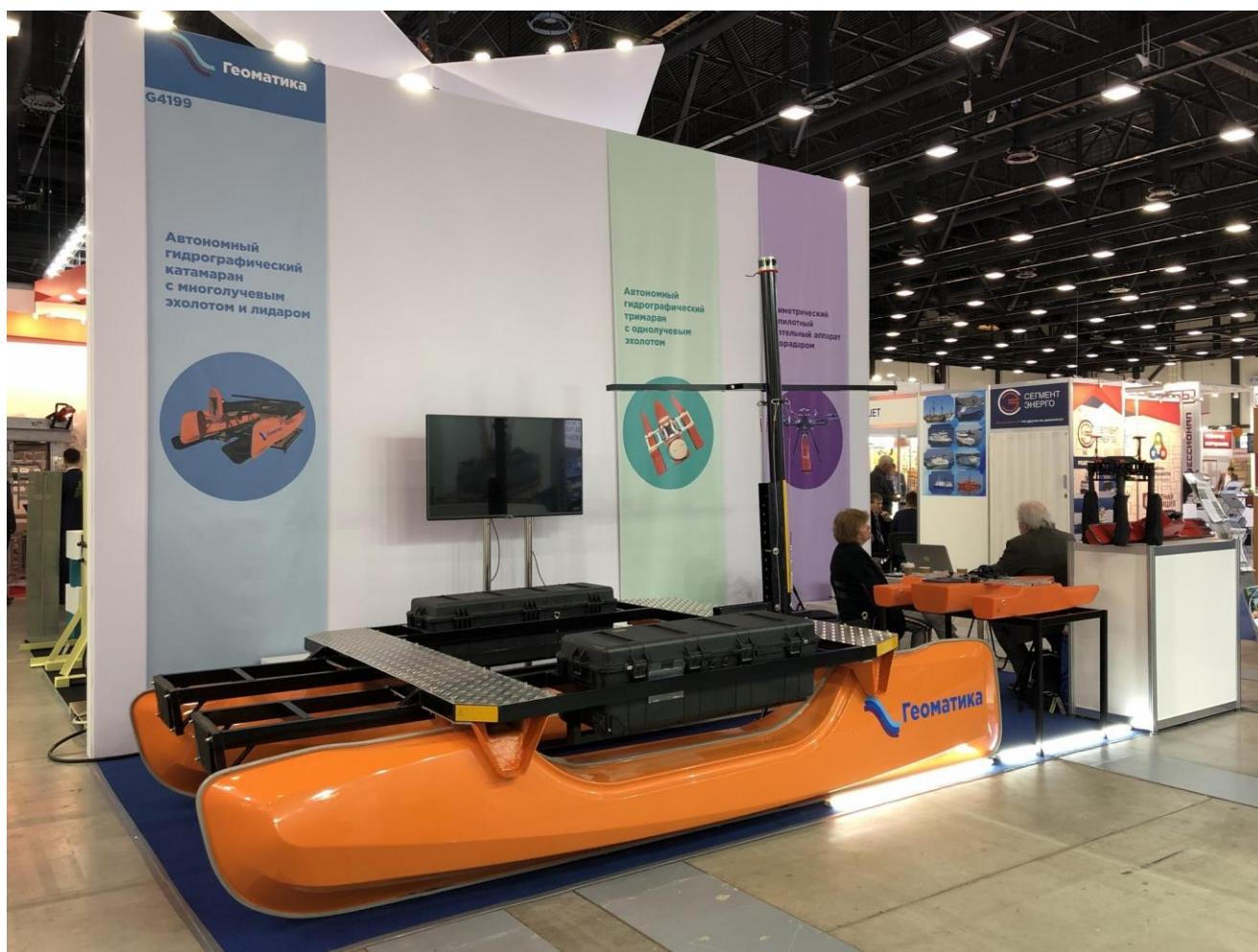
Гидрографический катамаран на стенде «Геоматики» с поднятой мачтой с лидаром и поперечной высокочастотного спутникового компаса инерциальной навигационной системы
