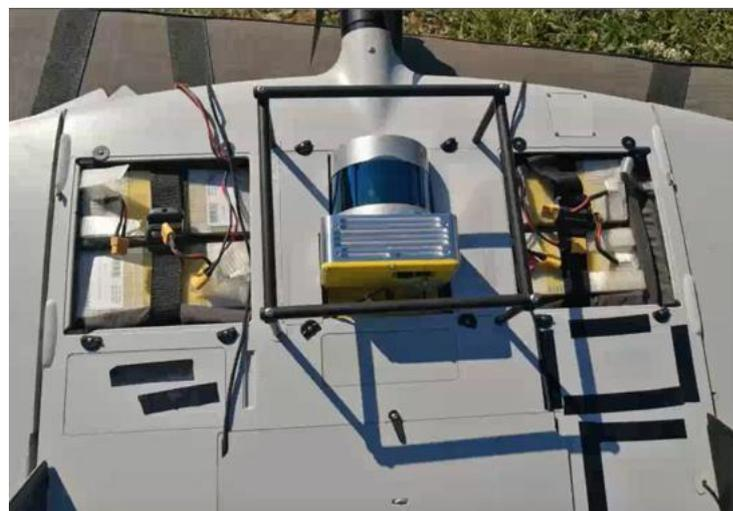
**Л-СКАН Премиум измеряет расстояние до поверхности земли сквозь листву деревьев, регистрируя двойное отражение.** Лидар работает на принципе определения времени прохождения импульса (ToF) и принимает двойное отражение, если отражающая поверхность (например, листва дерева) занимает только часть ширины луча. Таким образом, это позволяет измерять расстояние до поверхности земли сквозь листву деревьев. В этом режиме число регистрируемых точек увеличивается до 1,2 млн. точек.
